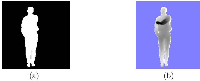
FIGURE 1 – Deux méthodes peuvent être utilisées pour extraire des informations purement géométriques. (a) Application d’un algorithme de soustraction d’arrière plan avec une caméra “classique”. (b) Application d’un algorithme de soustraction d’arrière plan avec une caméra de profondeur.
